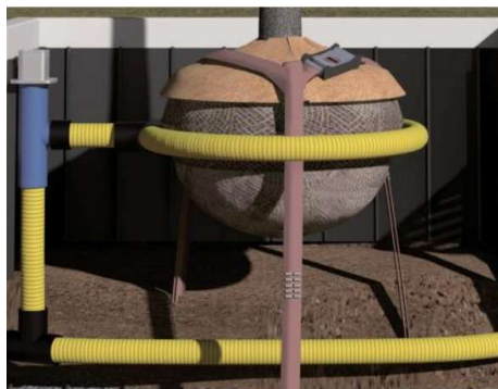
Schéma závlahové sondy a provětrávacího systému v rámci výsadbové mísy
